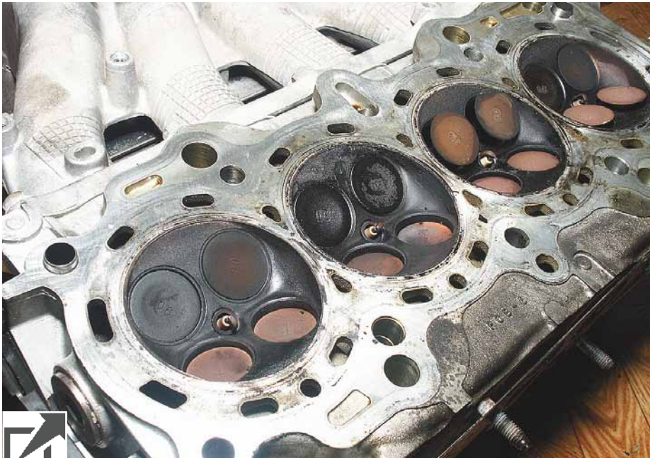
Идеальное состояние поверхности камер сгорания, клапанов и изоляторов свечей зажигания указывает на то, что двигатель продолжительное время работал на газе. Состояние головки можно было бы назвать отличным, если бы не одно «но»....
